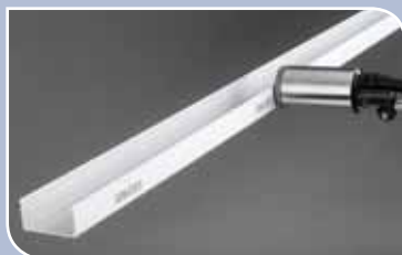
6000RPlus, запрограммированный для выполнения печати повторяющихся надписей через определенные интервалы на производственной линии экструдированных изделий.
