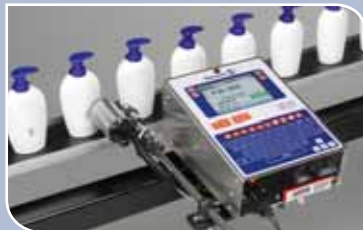
6000RPlus – Печать на боковых поверхностях бутылок.
